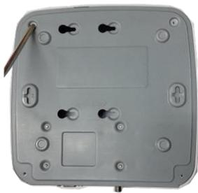
① Afloje los tornillos de la tapa superior y del panel lateral.
